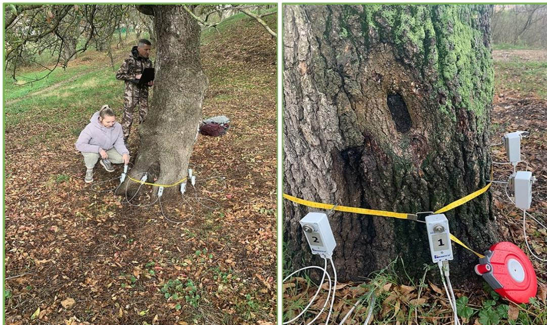
**Рис. 3** Исследование изменений древесины деревьев *Pistacia atlantica* Desf. в ботаническом памятнике природы «Ушакова балка» методом ультразвуковой томографии с применением комплекса оборудования Arbotom® ABT05-S (Rinntech, Германия)
