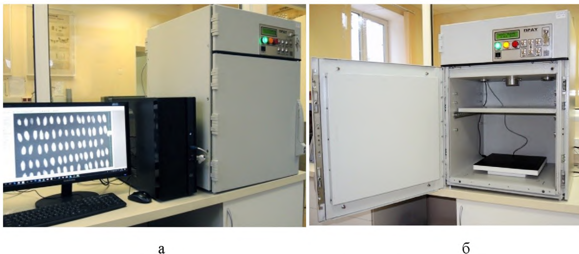
Рис. 1 Программно-аппаратный комплекс: а) общий вид, б) модернизированная рентгеноустановка с плоскоребрим приемником-матрицей
