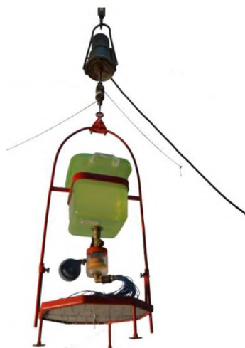
Рис. 2 – Портативная лабораторно-полевая дождевальная установка Fig. 2 – Portable laboratory-field rainfall simulator
