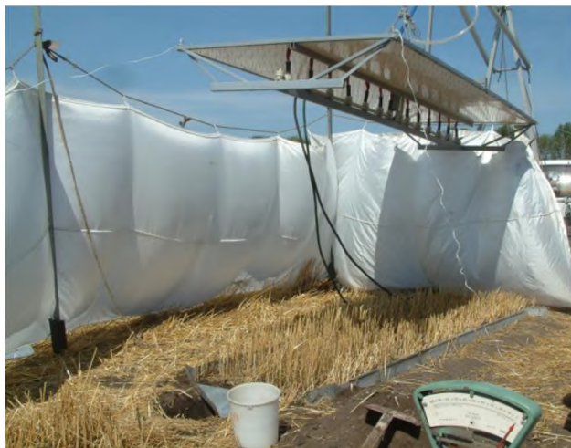
Рис. 1 – Лабораторно-полевая дождевальная установка Fig. 1 – Laboratory-field rainfall simulator
